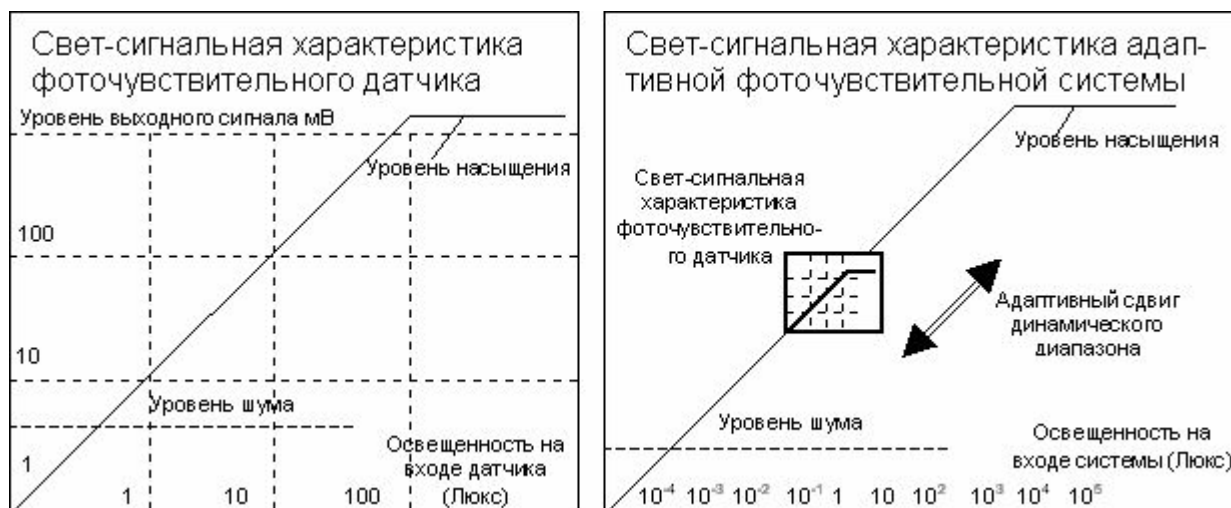
Рис.2 Иллюстрация расширения диапазона рабочих освещенностей фоточувствительного датчика, работающего в составе адаптивной фоточувствительной системы.
