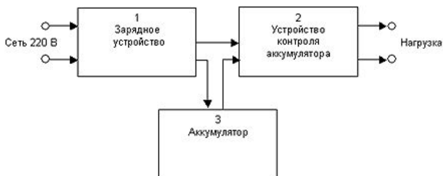
Рис. 4.2. Блок-схема источников резервного питания "СКАТ" группы P/5.
